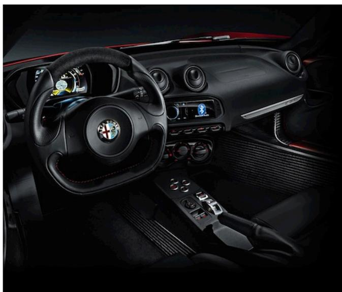
**Cambio "sprint"** - Per quanto concerne la trasmissione, la 4C è equipaggiata esclusivamente dal cambio 6 marce a doppia frizione Alfa TCT, soluzione che coniuga l'immediatezza del sequenziale alla comodità dell'automatico. Rispetto all'analogo sistema riguardante Mito e Giulietta, vi è il software completamente nuovo in grado di garantire la massima velocità nella selezione di rapporto in tutte le condizioni. In dettaglio, attuando la regolazione più sportiva la cambiata completa avviene
